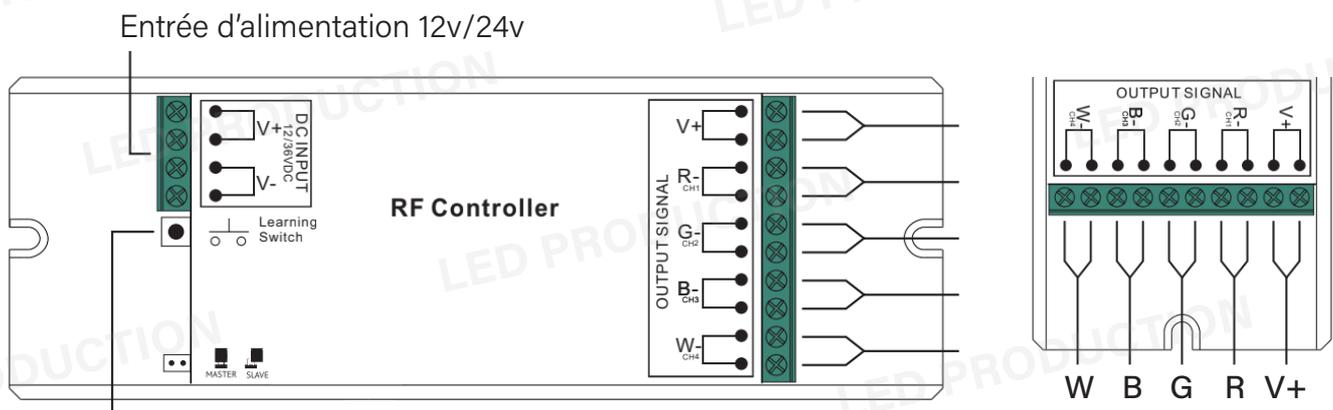
Appairer le récepteur à la télécommande : Cliquez 1 impulsion brève et rapide sur Key , puis 1 impulsion sur la zone souhaitée de la télécommande
